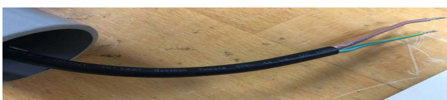
II.A.2.1.1 - Fiação interna e externa - Marcações do cordão de alimentação da luminária
