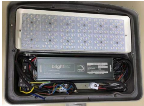
IP6X - Evidência de NÃO ingresso de pó no alojamento do controlador da amostra.
