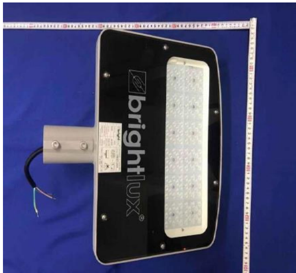
Foto 01 - Vista geral da luminária (a)
