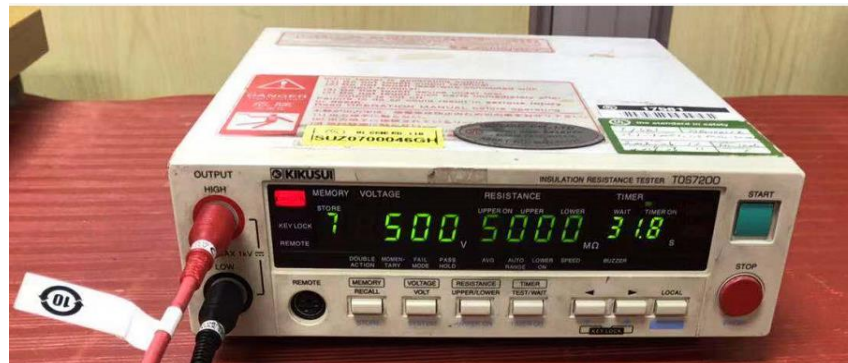
II.A.5.2 - Ensaio de resistência de isolamento da luminária
