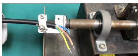
II.A.2.1.1 - Ensaio de tração do cabo de alimentação da luminária
