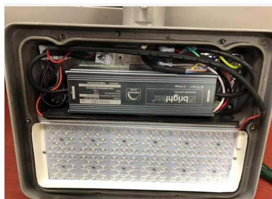
IPX6 - Evidência de NÃO ingresso de água no alojamento do controlador da amostra.
